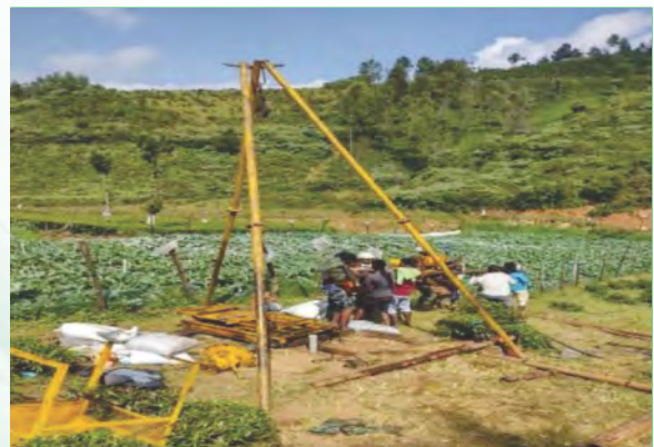
नदी के दाहिने किनारे पर ड्रिल होल में गुडमैन जैक परीक्षण का आयोजन
