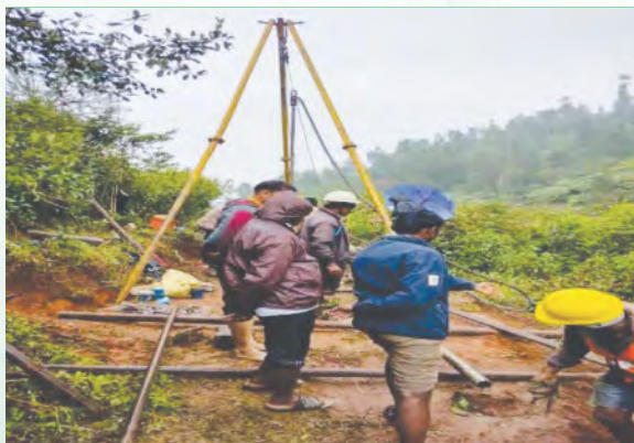
ऊपरी बांध स्थल पर सिल्लाहल्ला नदी के बाएं तट पर ड्रिल होल में गुडमैन जैक परीक्षण का आयोजन
